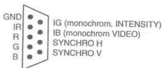
Rysunek 1.7. Schemat gniazda wyjściowego karty EGA
